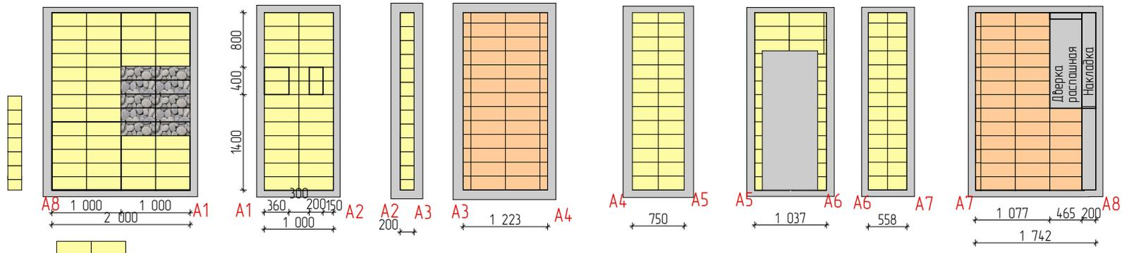
Развертки по стенам с раскладкой плитки в санитарном узле М 150
