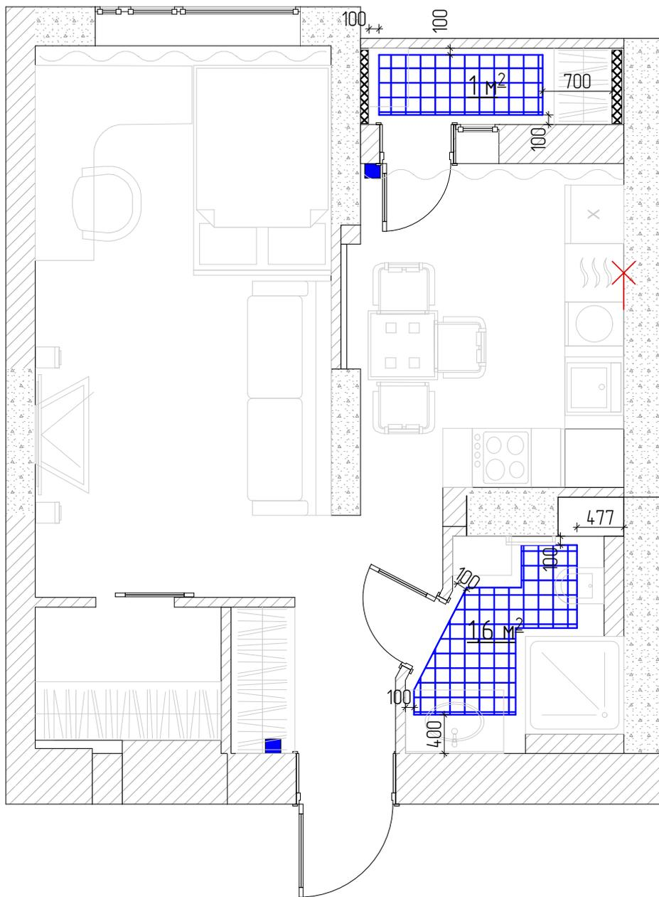
■ Регулятор теплого пола, Н от пола 600
